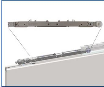
Die Einzugsdämpfer werden vorteilhaft in der Laufschiene geführt und können jederzeit, auch bei eingebautem Türblatt, justiert werden. ECLISSE BIAS bremst und zieht Türblätter bis 40 kg in der Schließbewegung an das Anschlagprofil. ECLISSE BIAS DS hat zusätzlich noch eine Bremsfunktion auf den letzten Zentimetern bei der Öffnungsbewegung des Türblattes.
