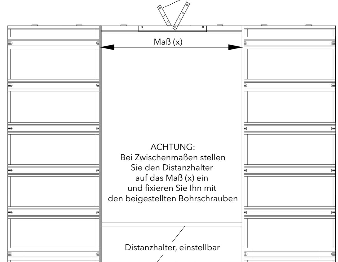
Stelle Sie den Distanzhalter auf die gewünschte Größe. Messen Sie die Distanz zwischen den Halteblechen um die Länge zu bestimmen und führen Sie zur Kontrolle eine Kreuzmessung durch
