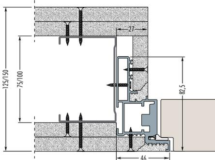
Die Zarge kann sowohl in eine Trockenbau- als auch in eine Massivwand eingesetzt werden.
