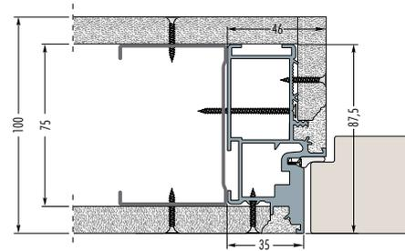
Trockenbauwand, Profil 50, zweimal belegt (GKB 12.5)
