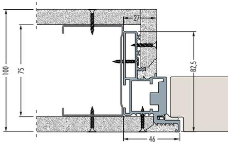
Trockenbauwand, Profil 50, zweimal belegt (GKB 12.5)
