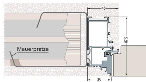
Trockenbauwand, Profil 75, einmal belegt (GKB 12.5)
