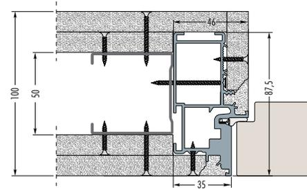
Trockenbauwand, Profil 75 oder 100, zweimal belegt (GKB 12.5)
