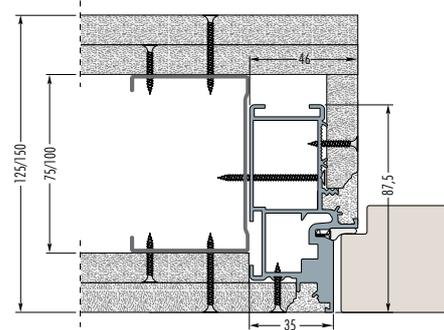
Achtung! Die Unterkonstruktion für die Zarge „Syntesis Wing“ ist lt. ÖNORM 3415 herzustellen. Bei einem Türblattgewicht über 25 kg (inkl. Beschläge) sind ausschließlich UA-Profile für den Anschluss der Zarge zu verwenden. Die Profildicke ergibt sich aus der gewünschten fertigen Wandstärke und der Beplankungsstärke. Die Profile sind raumhoch einzusetzen, inkl. Türpfosten-Steckwinkel oben und unten.
