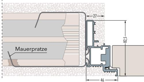
Trockenbauwand, Profil 75, einmal belegt (GKB 12.5)
