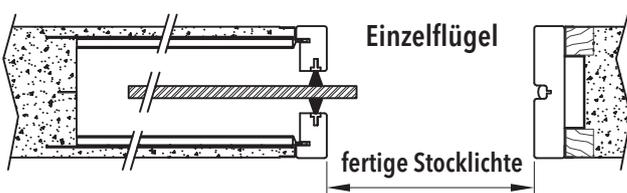
• Bestimmung des Breiten-Zuschnittmaßes für SYNTHESIS® LINE und SYNTHESIS® LUCE, 2-Flg. Systeme: Je Glasscheibe: Halbe fertige Stocklichte plus 30 mm
