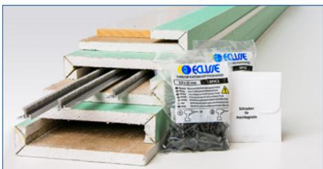
Die Planbox aus Gipskarton-Formteilen bietet eine einfache Möglichkeit um die Modellserie UNICO für Trockenbau optisch wandbündig zu verkleiden. Lieferbar für 1- und 2-flg. Modelle, für die fertigen Wandstärken 12,5 | 15 | 17,5 cm. Die passgenauen Formteile sind in Feuchtraumqualität GKBI 12,5 mm ausgeführt, inkl. Staubbürsten in Alu-Profilen, GK-Schrauben für zweite Belegung (3,9 x 32) und weißer Anschlagplatte aus Holzwerkstoff, geeignet zur Montage von Schließblechen.
