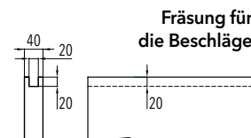
Fräsung für die Bodenführung
