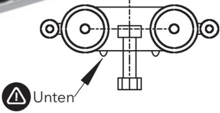
11 Beschlag auf obere Stirnseite Türblatt montieren
