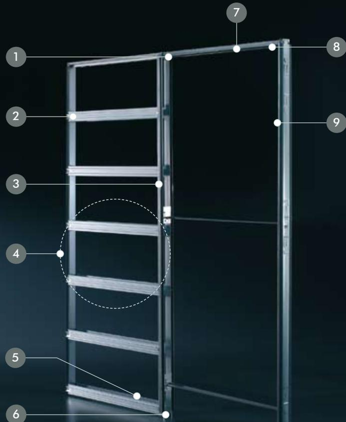
Die gezielt offene Bauweise des Schiebetürkastens für Trockenbau wird den zeitgemäßen Anforderungen im Innenausbau besser gerecht. Durch eine gleichmäßige Verschraubung der GK-Platte mit den speziell profilierten Querstreben entsteht der flächige Verbund mit dem Schubkasten. So verarbeitet, steift sich der Kasten optimal gegen Spannungen und Drücke aus. Werksseitig wird der Kasten für Profil 75 (fertige Wand 10 cm) oder Profil 100 (fertige Wand 12,5 cm) geliefert.
